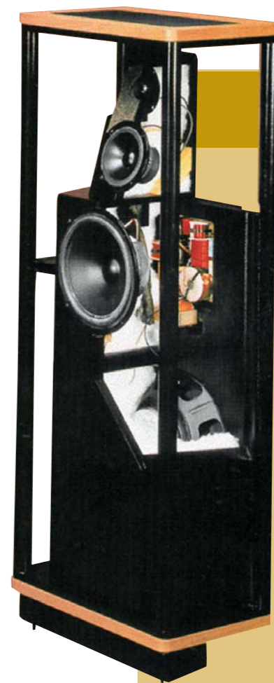
Разделительные фильтры первого порядка и смещенные относительно друг друга акустические центры излучения динамиков способствуют времякогерентности излучения
